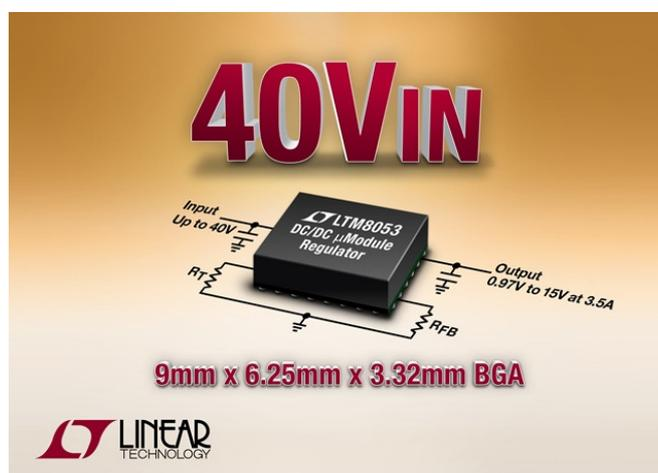
L'LTM8053 fornisce 3,5A di corrente di uscita continua (picco 6A), e il pin SHARE consente la condivisione della corrente, permettendo il funzionamento in parallelo per fornire una maggiore quantità di corrente. La tensione di uscita è regolabile da 0,97V a 15V. Questo ampio intervallo di tensione in uscita consente grande versatilità, per cui il dispositivo genera tensioni del bus di sistema comune di 3,3V, 5V, 12V e 15V. L'efficienza da 12V<sub>IN</sub> a 5V<sub>OUT</sub> è del 90%. L'LTM8053
