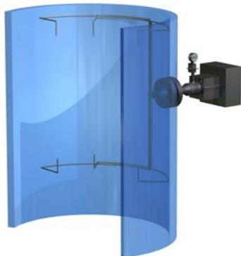
Percorso delle termocoppie all'interno del reattore
