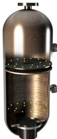
**Distribuzione radiale dei punti di misura in verticale all'interno di un reattore**
