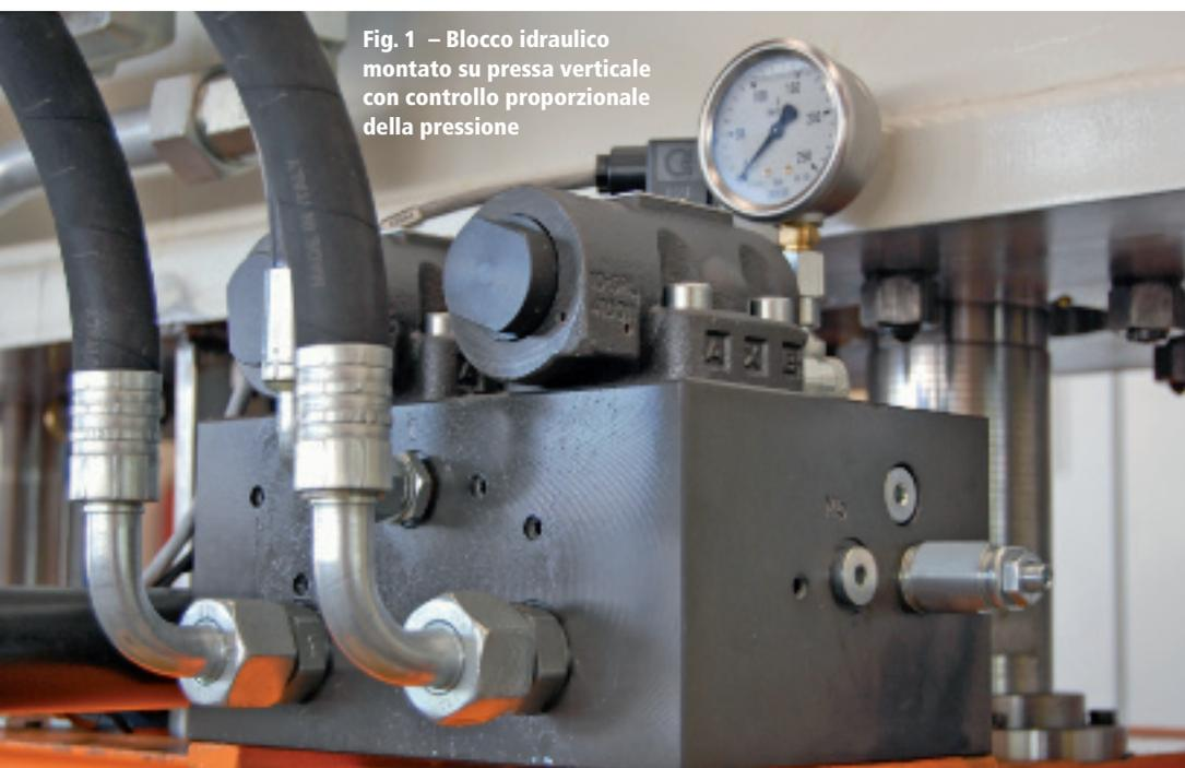
Fig. 1 – Blocco idraulico montato su pressa verticale con controllo proporzionale della pressione
