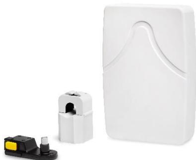
WIBEEE in versione BOX è dotato di uno o più trasformatori amperometrici apribili e di un morsetto magnetico da collegare sul magnetotermico. Si installa senza dover svitare nemmeno una vite. Il principio di misura non cambia, aumenta invece la flessibilità di installazione. Potrai per esempio monitorare tre carichi monofase contemporaneamente oppure integrare la produzione del tuo impianto Fotovoltaico.
